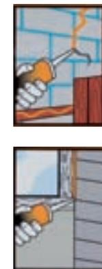
Sellado en exterior, estanqueidad, aislamiento, ensamblaje para construcción, juntas de dilatación, elementos de construcción en general. Muy buena adherencia en hormigón, aluminio, madera, metales.
